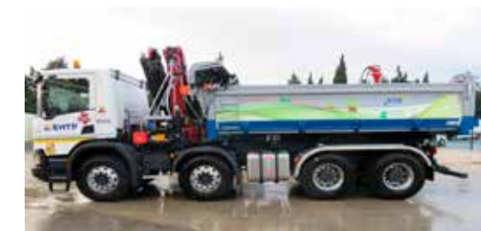
Camión Scania 8x4 que funciona con bioetanol
